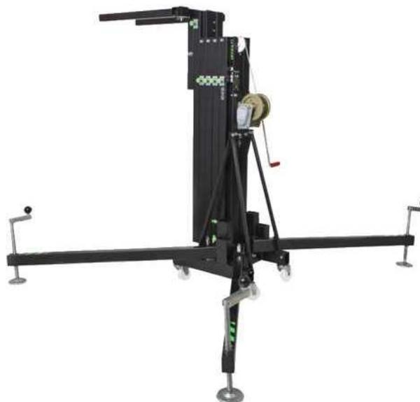
**CARACTERISTIQUES:** L'élévateur K-50 de nouvelle génération offre une plus grande hauteur de levage avec 5m95 de hauteur maximum. Il intègre le dispositif de verrou automatique de type KAT qui bloque les mâts lors de l'élévation et empêche la chute de la charge dans le cas improbable d'une rupture du câble acier.
